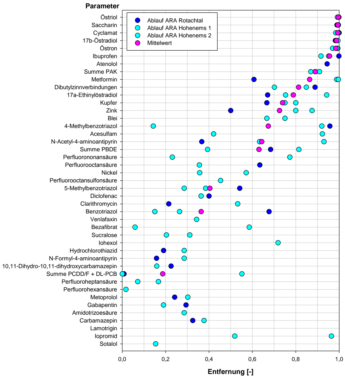
Abbildung 11: Entfernung der untersuchten Spurenstoffe in den beprobten Kläranlagen
